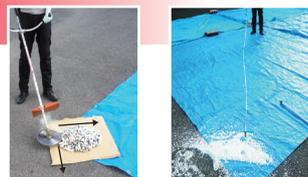
**試験2** 10kgの砂を台の上にやまもりにして各チップソー、同条件(回転数)でゆっくり右から左に首を振りながら奥へ徐々にスライドさせていきました。一般型チップソーの方が全体的にちらばっているのに比べ、石飛低減チップソーの方が**手前に集中してちらばり飛散が少ない結果になりました。**
